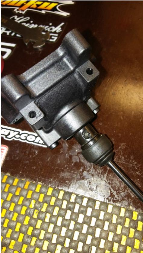
Die Madenschrauben für die mittleren Antriebswellen müssen sehr gut entfettet werden. Diese klebe ich mit Naben und Wellen Sicherung endfest ein. Zum Lösen muss man sie heiß machen, hat aber den Vorteil, dass sie da bleiben wo sie sollen.
