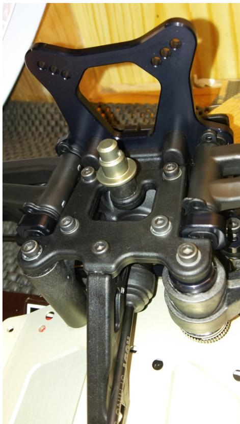
Ich verwende an allen Stellen, an denen man auf dem Rennen schnell dran muss, Zylinderkopfschrauben. Wenn Dreck im Schraubenkopf ist dreht man sie nicht so leicht rund und im Notfall kann man sie mit einer Zange rausdrehen.
