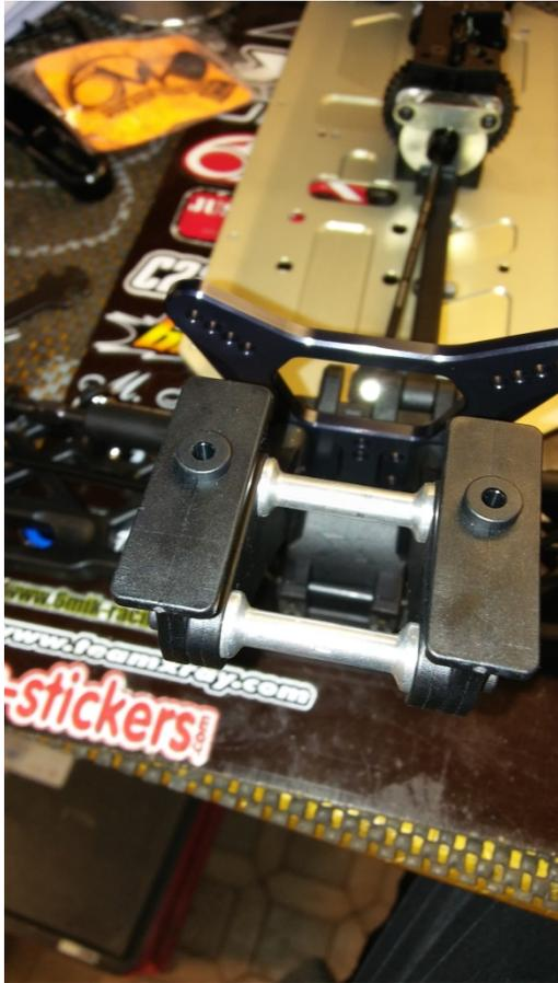
Die Alu Wing Mount Brace #353550 und die Wing Shims #353561 sollte man einbauen, diese sind stabiler. (Sie halten auch mehrere Buggys durch)
