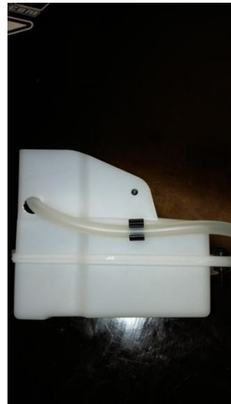
Den Spritschlauch verlege ich auf der anderen Seite um zu verhindern, dass die Karosse am Spritschlauch scheuert, abknickt oder den Schlauch in den Tank drückt und das Pendel klemmen könnte. Es ist wichtig zu beachten, dass der Spritschlauch nicht höher als der Anschluss am Vergaser liegt. Den Druckschlauch lege ich über den Düsenstock, somit kann er nicht in die Kupplung geraten.
