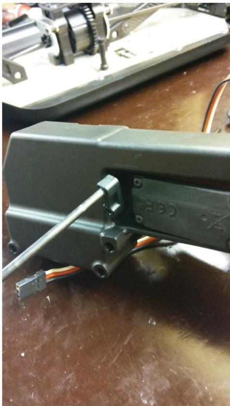
Für die Servomontage hab ich einen Trick. Ich stecke die Gegenstücke für die Schrauben auf einen 2.5 Schlüssel um sie gegen die Schrauben zu drücken.
