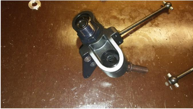
Die Adjusting Nut kann man mit der Hand ansetzen und dann sauber einschrauben. Das verhindert das zerstören des Gewindes.
