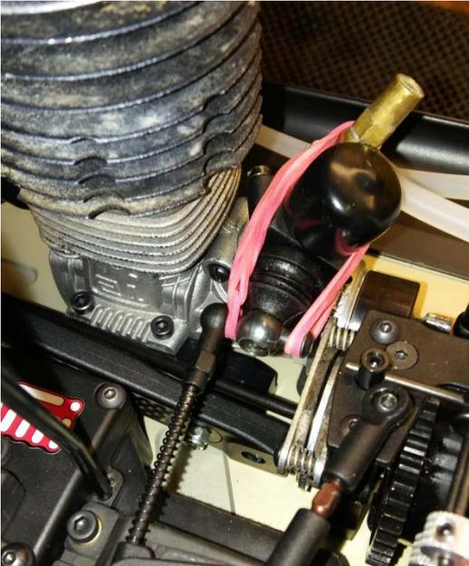
An Stelle der Madenschraube benutze ich eine M3x8 Linsenkopfschraube, um den Gummi zum Rückholen des Vergaserschiebers zubefestigen. So ist gewährleistet, dass gleichmäßiger Druck auf dem Vergaserschieber lastet und sich keine Kante in der Führungsnut einarbeitet. Zur weiteren Sicherung nutze ich die Feder am Gestänge.
