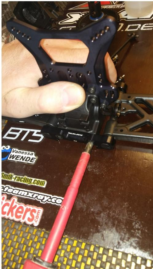
Beim ersten Montieren der Diffgehäuse ist es wichtig diese wirklich extrem fest anzuziehen. (Die Gehäuse müssen sich ineinander schieben) Sonst kommt es zu dem oft beklagten Problem von wackelnden Diffs. Die oberen Gewindeschrauben sowie die unteren Kreuzschrauben.
