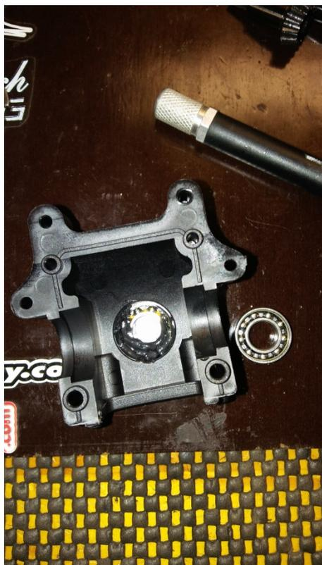
An den Kugellagern in den Diffkästen entferne ich alle Dichtscheiben, außer die äußere (zur Antriebswelle). So kann man die Lager besser schmieren und im Falle eines Defekts verklemmt sich keine Dichtscheibe in den Zahnrädern.
