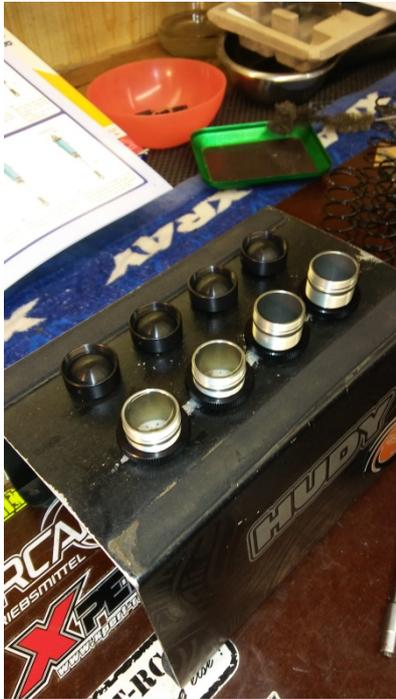
Beim Dämpferfüllen ist es wichtig, dass die komplette Luft aus dem Öl entweicht. Dazu lasse ich sie längere Zeit stehen. Auch hier weicht meine Basis von dem Standardsetup ab. Vorne benutze ich 8x1.2 mit 700er Öl und hinten 8x1.3 mit 550er Öl.
