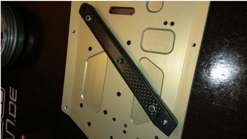
Ich empfehle die Verwendung der Kohlefaser Einlagen für die hintere Chassisstrebe. Ebenfalls können in den Seitenwannen Kohlefaserplatten eingesetzt werden.
