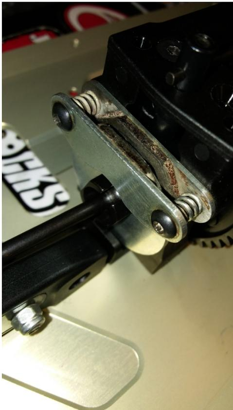
Ich verwende die Tuning Bremsscheiben #354131. Sie ermöglichen ein besseres Dosieren der Bremse und haben kaum Fading. Ich verwende dieselbe Bremse jetzt schon im dritten Buggy.
