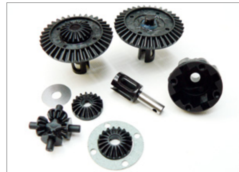
Solide Abtriebe aus Federstahl stehen Kegelrädern aus faserverstärktem Kunststoff gegenüber. Eine Kombination, die nicht nur leicht, sondern auch stabil ist – vorausgesetzt, man justiert alles sehr penibel mit Unterlegscheiben aus
