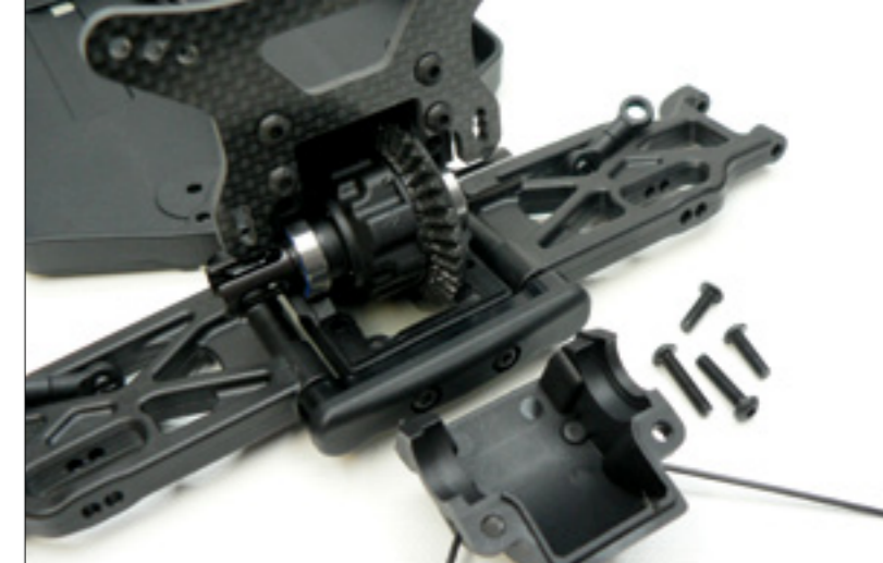
Die recht grob verzahnten Tellerräder müssen sehr fein mit Unterlegscheiben justiert werden, die dem Set leider nicht beiliegen. Die Demontage der Differenziale geht schnell und ohne vollständiges Auseinandernehmen der Querlenkerhalter vorstatten
