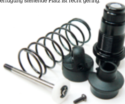
Die Dämpfer und die beiliegenden Federn sind gut auf Blue-Groove-Strecken abgestimmt und sauber gefertigt. Warum XRAY aber die oberen O-Ring-Dichtungen erst als separate Teile anbietet, erschließt sich nicht – ohne diese sind die Dämpfer oben schlicht zu schnell undicht
