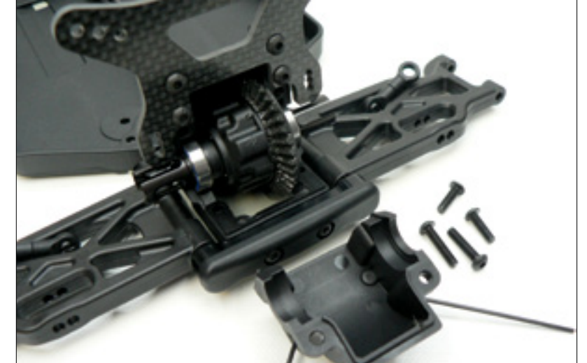
Die recht grob verzahnten Tellerräder müssen sehr fein mit Unterlegscheiben justiert werden, die dem Set leider nicht beiliegen. Die Demontage der Differenziale geht schnell und ohne vollständiges Auseinandernehmen der Querlenkerhalter vorstatten
