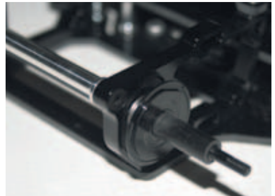
Die Hinterachse sitzt in einem äußerst verwindungsfesten Powerpod
