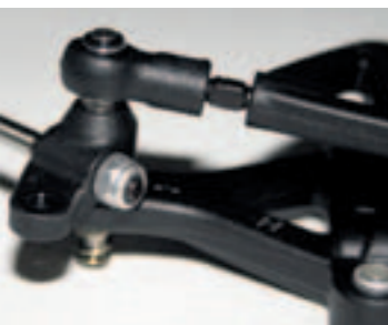
Der Sturz wird über stählerne Rechts-links-Gewindestangen eingestellt
