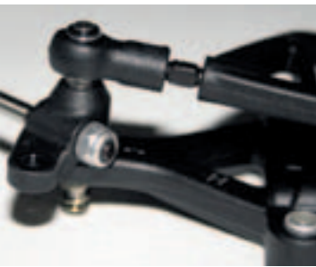
Der Sturz wird über stählerne Rechts-links-Gewindestangen eingestellt
