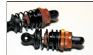
SLP, also Super Low Profile heißt das Zauberwort bei den Stoßdämpfern
