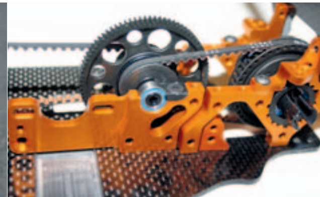
Alles ist soweit wie möglich zur Fahrzeuglängsachse gerückt
