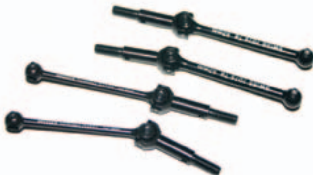
Federstahl (unten) für vorne, Aluminium für hinten
