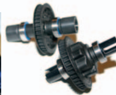
Neu ist das Kegeldiff, ein Spool an der Vorderachse ist geblieben
