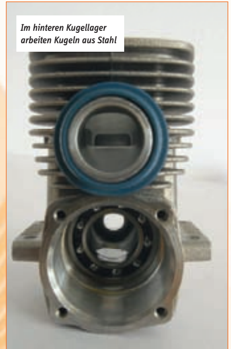
Das vordere Lager ist mit Dichtlippen abgedichtet
